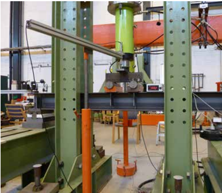
Hållfasthetstest av stål balk.
